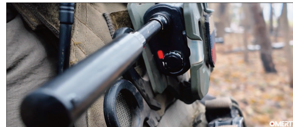
Gerät zur Erkennung der Frequenz von Drohnen. Jeder Soldat trägt ein solches Gerät. Das Signal ist akustisch. Foto aus dem Film Omerta.
